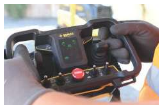
Kabel- en frequentiebediend
